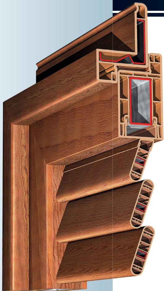
CAPRI-ISCHIA sono sistemi di profilati per la costruzione di persiane in PVC a lamelle orientabili, distanziate, cieche e tamponamenti a doghe. L'ottima stabilità è dovuta al rinforzo tubolare e alle squadrette in alluminio. È possibile realizzare persiane scorrevoli e scegliere fra tre tipi di montaggio: su telaio, monoblocco o diretto aggancio a muro. Inoltre, su richiesta, possono essere inserite serrature con triplice chiusura.
