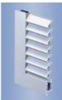
Il Sistema Capri-Ischia è un sistema di profilati per la costruzione di persiane in PVC a lamelle orientabili, distanziate, cieche e tamponamenti a doghe. È possibile realizzare persiane scorrevoli e scegliere fra tre tipi di montaggio: su telaio, monoblocco o diretto aggancio a muro. L'ottima stabilità è dovuta al rinforzo tubolare ed alle squadrette in alluminio.
